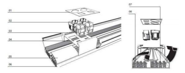
Os pontos de saída junto aos postos de trabalho deverão possuir tomadas modulares (U/UTP) de 8 (oito) vias, contatos banhados a bronze fosforoso 50 micropolegadas de ouro e 100 micro-polegadas de níquel, padrão RJ45.
