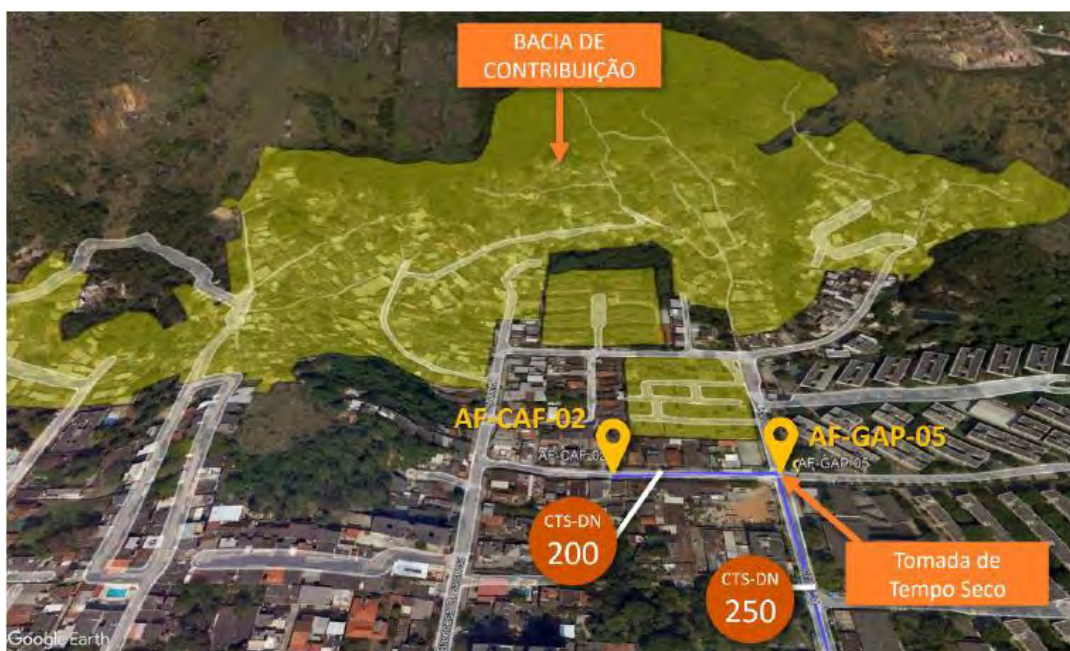
Figura 10 - Área de atendimento e situação – AF-CAF-02 e AF-GAP-05
