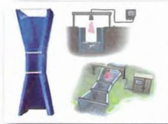
FIGURA 1.54 – MEDIÇÃO DE VAZÃO POR MEDIDOR ULTRASSÔNICO EM CALHA PARSHALL DE PRFV
